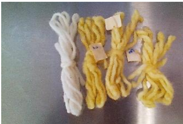
Figura 5 Fotografía donde se observa la fibra de lana antes y después de ser teñida con 50% de girasol fresco sobre el peso de la tela
