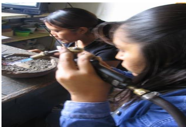
Figura 1 Proceso de fundición de la plata
