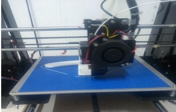
Figura 19 Base de sujeción para resortes
