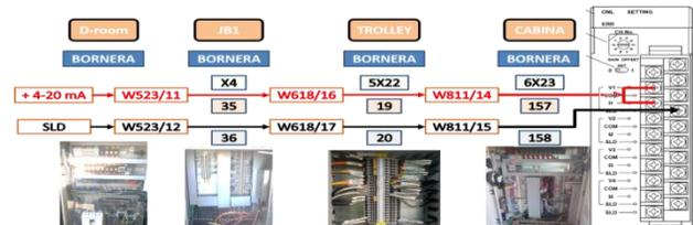
**Figura 10** Ruta para Cableado Seccional
