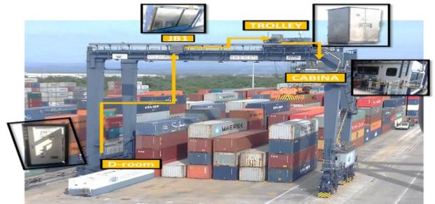
**Figura 9** Layout de Ruta para Cableado
