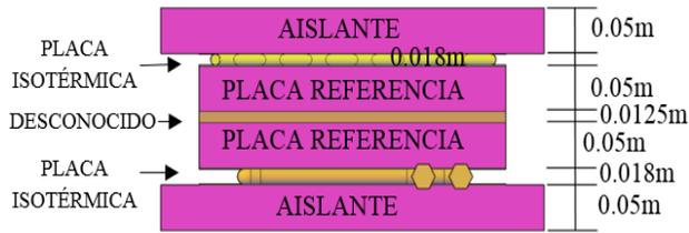
**Figura 2** Espesores y configuración de las placas empleadas en el sistema
