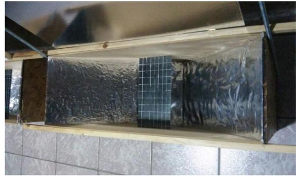
**Figura 7** Vista superior del concentrador y reflector.
