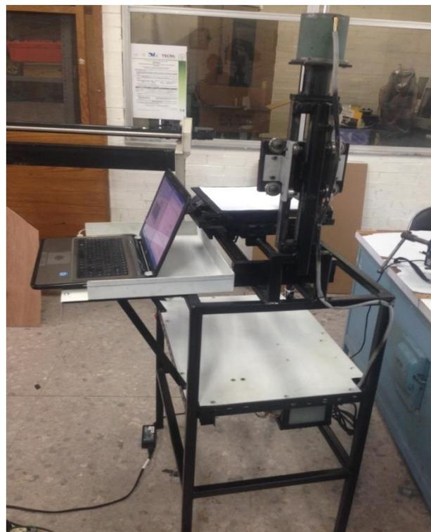
**Figura 1** Equipo posicionador en los ejes XYZ
