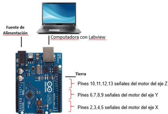
**Figura 5** Conexiones de la tarjeta Arduino
