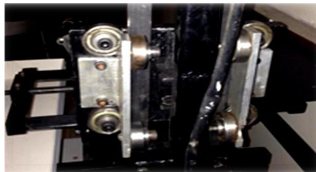
**Figura 4** Sistema de baleros para el eje Z
