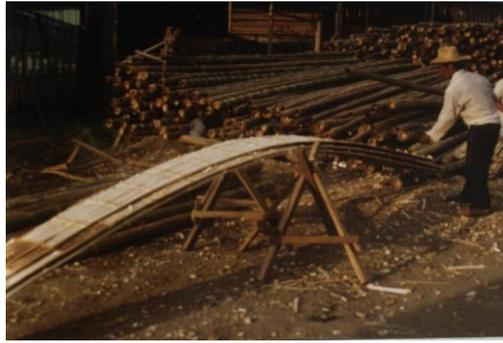
Este procedimiento es completado por la limpieza que se debe realizar a los latones de los restos de nudo que entorpecerían la manipulación y le quitarían flexibilidad a los elementos. Esta es otra forma de mayor aprovechamiento del material en otra diferente al rollizo de bambú.
