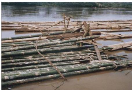
Curado por inmersión en agua. Consiste en sumergir las guadúas después de cortadas en un estanque o en un río por menos de un mes, es el menos recomendable ya que las guaduas se manchan y se vuelven quebradizas.
