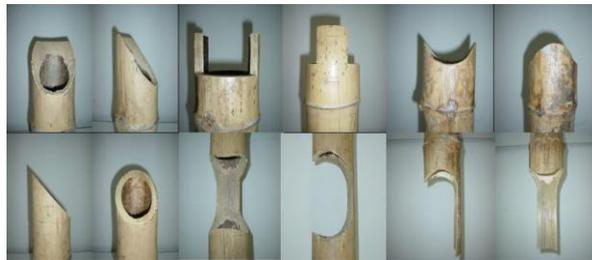
Los cortes son realizados según el requerimiento del diseño estructural y la forma que requieran las uniones para poder ensamblar los diferentes componentes de las estructuras.
