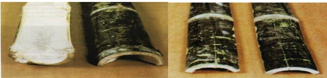
Abierta, picada, esterilla o charqueada. Es el procedimiento por el cual los rollizos de bambú son abiertos con las herramientas necesarias a fin de obtener elementos flexibles que pueden ser manipulados según el uso que se le pretenda dar, a estos elementos también se los conoce como medio latón, latones, y latillas respectivamente y son utilizados en su mayoría para realizar entramados de soporte para muros bahereque.
