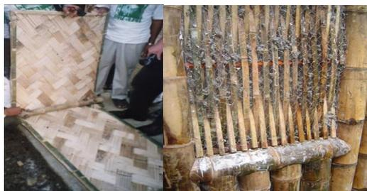
Tejidos. Estos están compuestos de entramados de diferentes diseños que son de uso visto en muros bahereque en la construcción y como bases materiales para los laminados en la industria.
