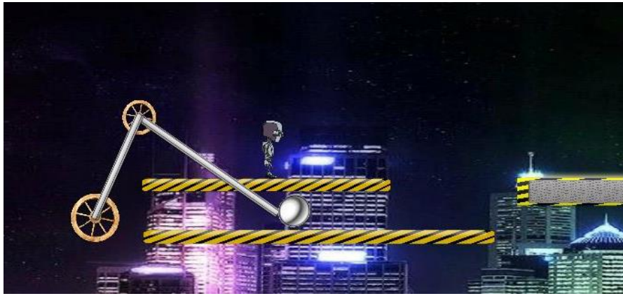
Figura 4.6 Mecanismo biela – manivela – corredera en el videojuego de Alonso
